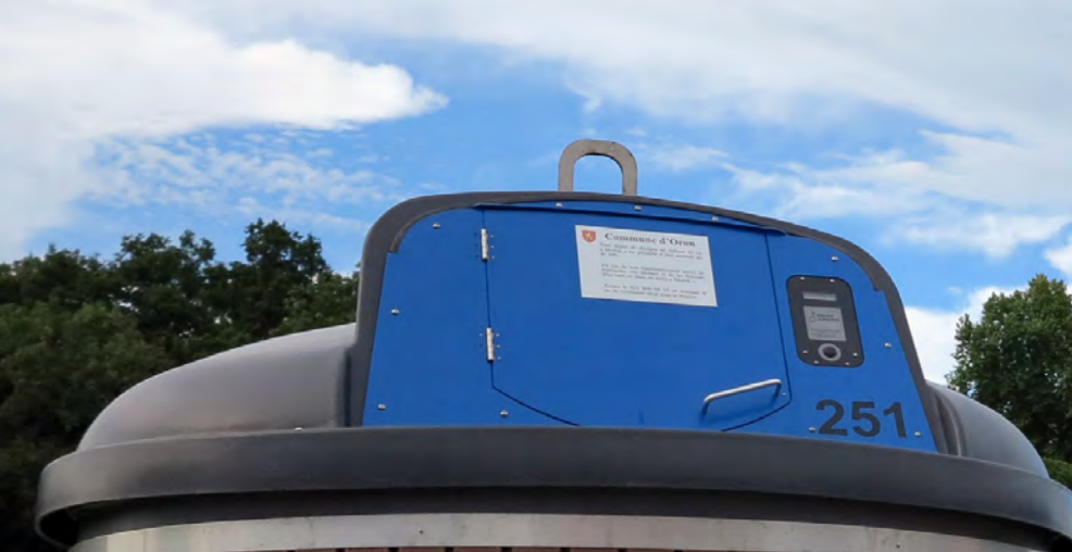
Conteneur semi-enterrés avec système de pesée individuelle des sacs.
